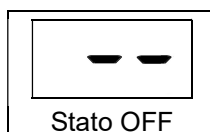
Figura 2 : Display con scheda nello stato OFF
